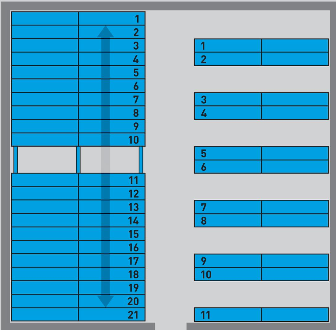
Gegenüberstellung eines konventionellen, fest installierten Lagersystems mit einer Hupfer Schieberegalanlage. Die Lagerraumnutzung erhöht sich im Idealfall um bis zu 100%.
