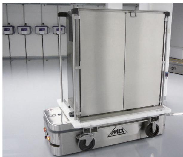
*Sistema de transporte sin conductor con carro de transporte Känguruh-System*
